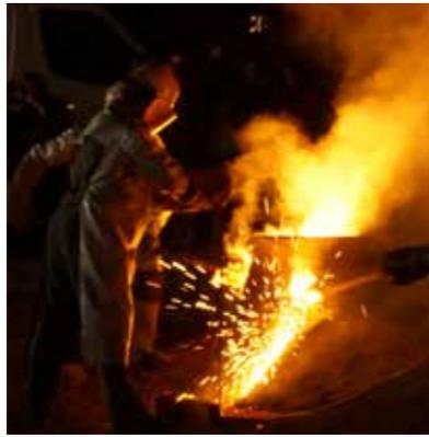
La densité de l'airain est de 9 : cela veut dire qu'un litre de métal en fusion pèse 9 kg lorsque les fondeurs versent le liquide avec leur louche. Compte tenu des exigences de maintien de température et du caractère très physique du remplissage de la cloche, une équipe de 6 fondeurs est nécessaire pour réussir cette opération délicate.
